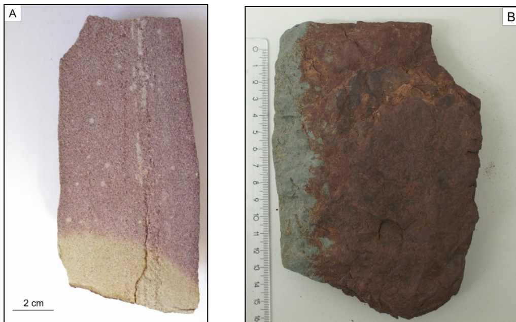
Abbildung 50 A): Scharf begrenzter Kluftbleichungsrand der Sandsteinprobe (suB) von Dorndorf-Kieselbach. B): Diffus begrenzter Rand einer Kluftbleichung aus dem Rotliegenden (Tambach-Formation).
